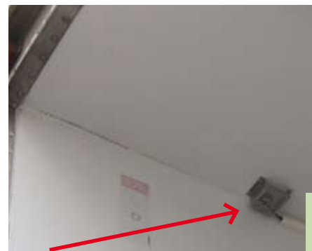
Čidlo v prostoru nákladu snímá teplotu a hodnoty přenáší na display teploměru.
