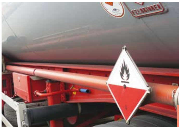
Požadavky na konstrukci a schvalování vozidel určených k přepravě nebezpečných věcí stanovuje část 9 dohody ADR.
